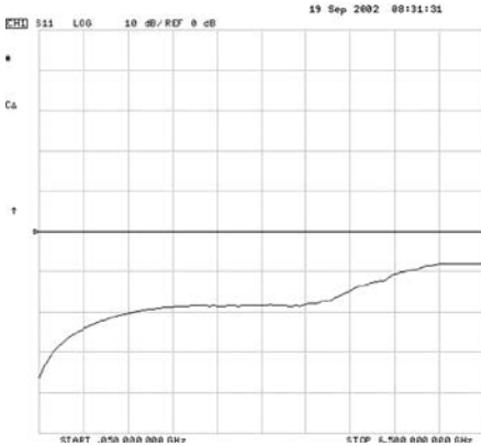
Abb. # 23 Rückflussdämpfung gemessen bis 6,5 GHz an einem Reedrelais wie in Abb. # 9 abgebildet. Horizontale Skalierung: 6,5 GHz. Vertikale Skalierung: 1,0/ Div bezogen auf die Grundlinie.
